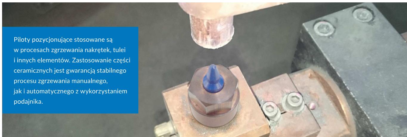
Piloty pozycjonujące stosowane są w procesach zgrzewania nakrętek, tulei i innych elementów. Zastosowanie części ceramicznych jest gwarancją stabilnego procesu zgrzewania manualnego, jak i automatycznego z wykorzystaniem podajnika.
